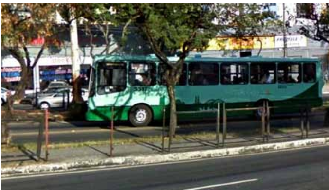
Gradil ao longo de uma faixa de ônibus em Belo Horizonte, Brasil, retirado para permitir a travessia em meio de quadra. Foto de Carsten Wass.
