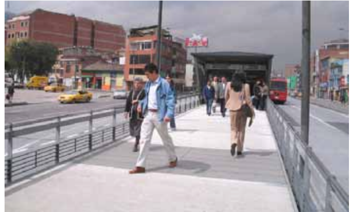
TransMilenio 2006: uma ligação entre duas plataformas em uma mesma estação. Observa-se que os baixos, de aproximadamente 1 metro de altura, permitem que as pessoas pulem por cima facilmente. Este era um importante risco à segurança de pedestres. Foto EMBARQ.
