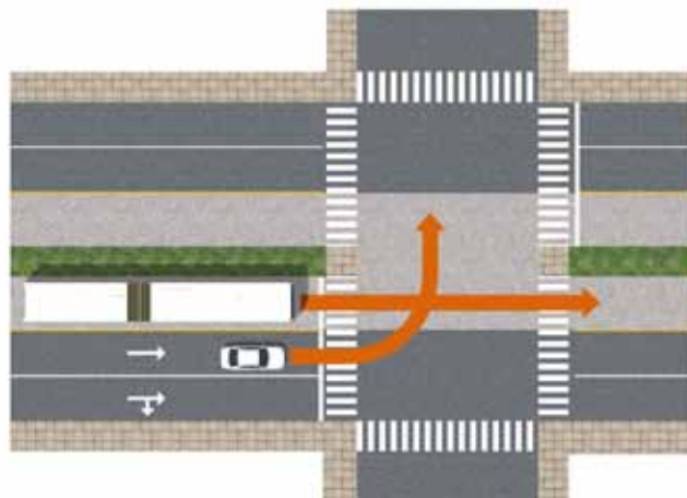
Diagrama do acidente: o tipo mais comum de acidente envolvendo ônibus em BRT ou corredores de ônibus em faixas centrais: carros que fazem conversão à esquerda ilegalmente na frente dos ônibus.
