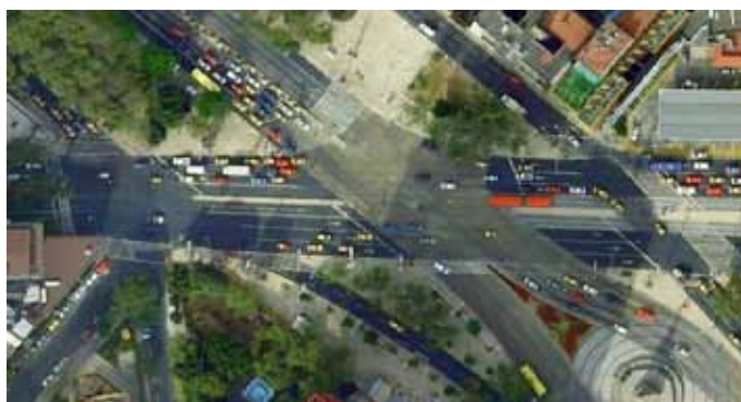
Uma interseção ampla e complexa ao longo da Linha 1 do Metrobús na Cidade do México. Este tipo de desenho tem mais problemas de segurança do que a interseção simples e estreita da imagem acima. Imagem do Google Earth.
